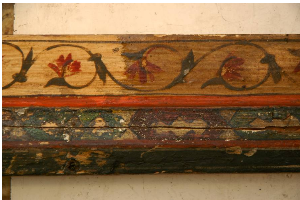
Felületek a fenyőgyanta-bevonat oldószeres eltávolítása közben
