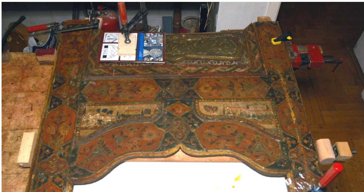
Repedések összehúzósa és ragasztása, szerkezeti megerősítés
